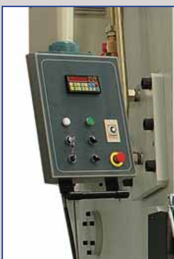
Posizionatore di quota per il registro 800 mm standard (1000 optional). PRG 911 nuova elettronica.
