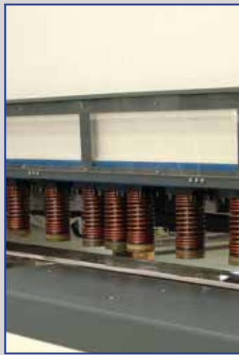
Riparo anteriore con micron di sicurezza, ribaltabile, per un facile accesso.
